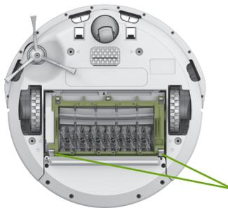
Фиксаторы рамки чистящего модуля
